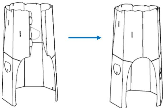
Insérer les crochets de fixation pour fermer l'arbre.
