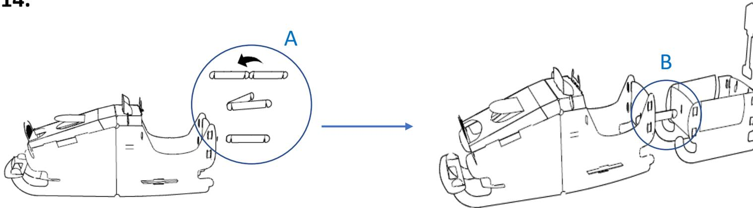
Pliez l'élément d'attache (A) et connectez le chariot et le partie pilotage de la luge grâce aux fentes (B).
